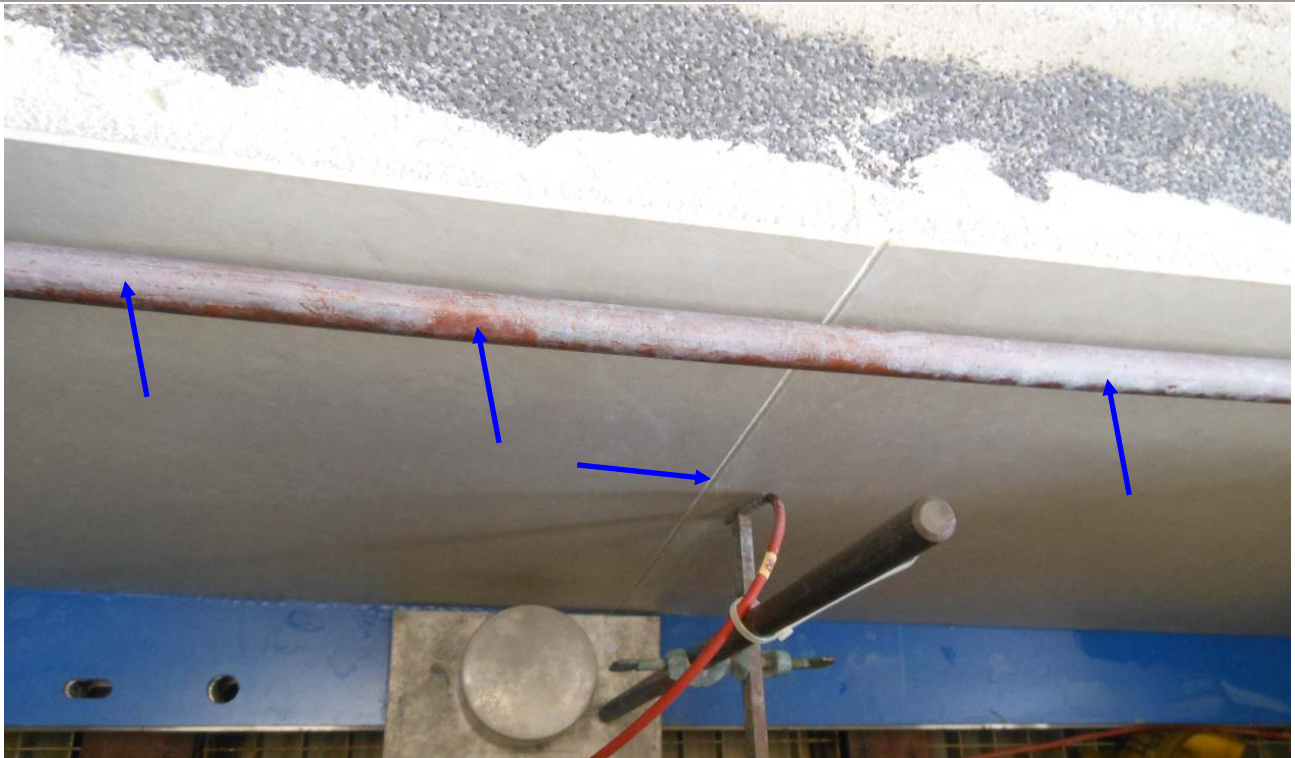
Figura 3. Riproduzione fotografica di un particolare del pannello “TermoK8 Modular Big” prima dell’inizio dei cicli Heat-Rain. Sono visibili, indicati dalle frecce di colore blu, la termoresistenza posizionata a diretto contatto con la superficie del pannello ed il tubo metallico tramite il quale viene eseguita la fase di irrorazione con flusso d’acqua (1 ora per ciascun ciclo Heat-Rain).
