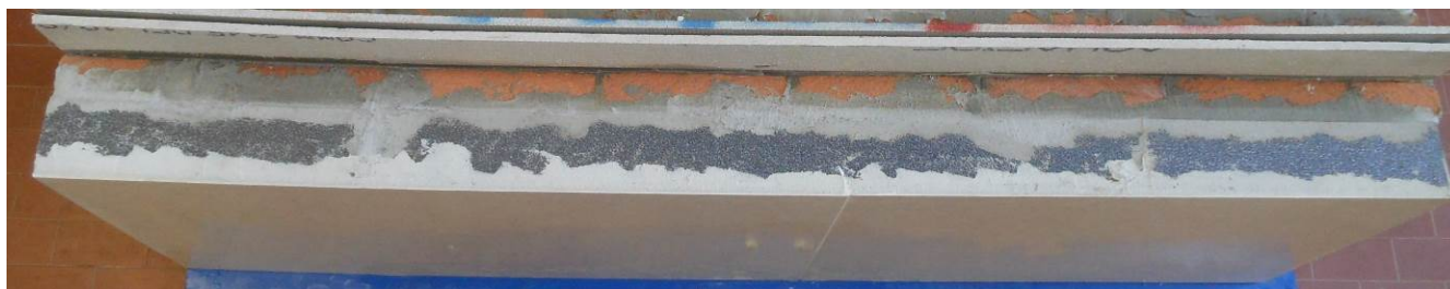
Figura 7. Riproduzione fotografica, al termine degli 80 cicli Heat-Rain + 5 cicli Heat-Cold e prima dell’esame visivo di aspetto, del pannello “Termok8 Modular Big”.
