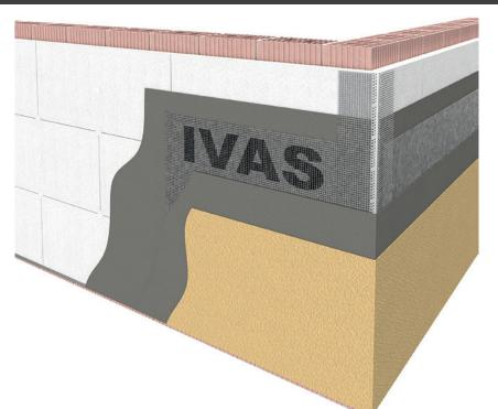
Soluzione ideale per ottemperare con semplicità ed efficacia alle disposizioni in materia di efficienza energetica assicurando tutti i vantaggi di un rivestimento a cappotto di qualità sia in sede di costruzione che manutenzione. La lastra isolante di questo sistema soddisfa i requisiti dei Criteri Ambientali Minimi per l'Edilizia. Reazione al fuoco del sistema: Euroclass B-s1,d0
