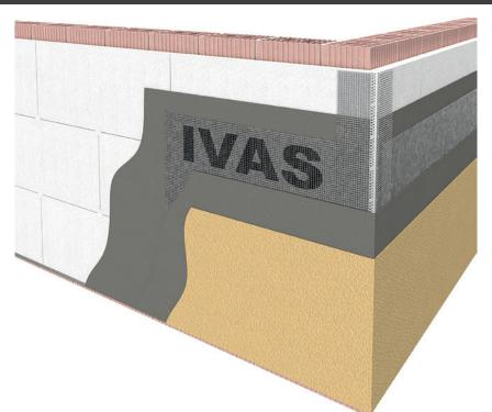
Solución ideal para cumplir con sencillez y eficacia las disposiciones en materia de eficiencia energética asegurando todas las ventajas de un revestimiento de capa de calidad tanto en la construcción como en el mantenimiento. La placa aislante de este sistema cumple con los requisitos de los criterios ambientales mínimos para la construcción. Reacción al fuego del sistema: Euroclass B-s1,d0
