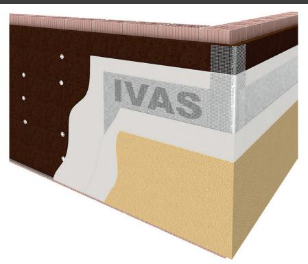
Solución ideal en el ámbito del diseño bio-construcción; además de la composición mineral, utiliza como aislante corcho ámbar natural, dotado de certificación de eco-compatibilidad.
