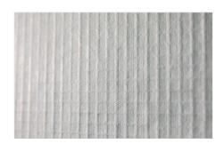
Panel aislante semirrígido nanotecnológico en Aerogel, idóneo para el aislamiento de bajo espesor.
