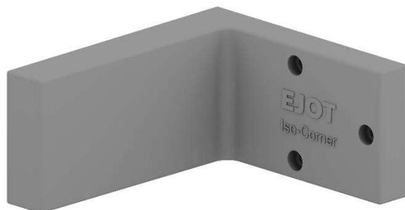
**Elemento di fissaggio in poliuretano ad alta densità per il fissaggio nei sistemi ETICS di carichi senza formazione di ponte termico sul fronte facciata. Selezionabile a misura direttamente in cantiere (anche in posa).**
